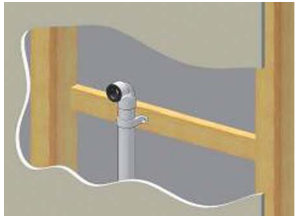
Obr. 15: Příprava připojení odvodu kondenzátu na svislý odpad
