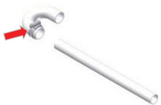
Obr. 16: Montáž hadice na kondenzát ve tvaru U
